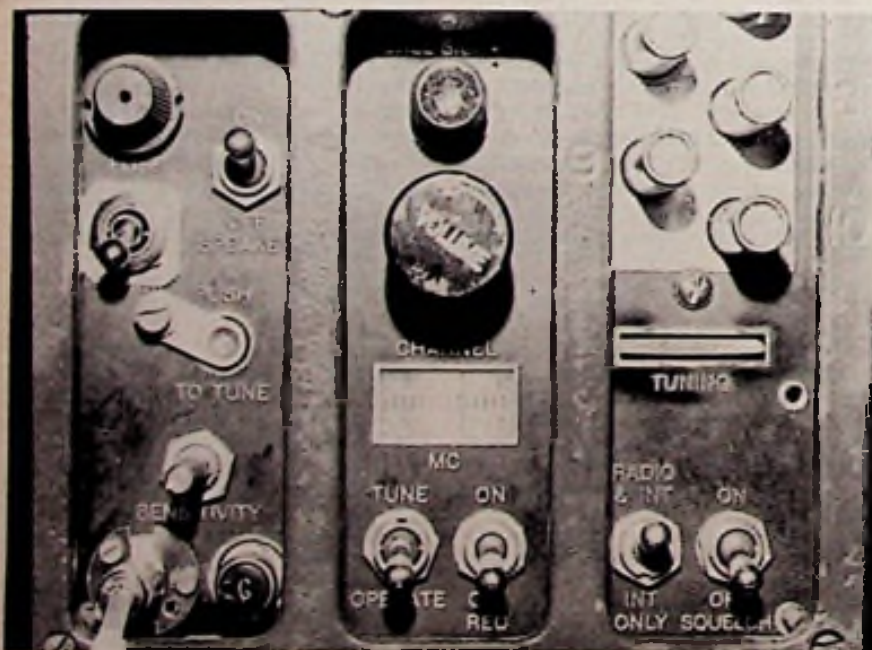
Afb. 16. Het bedieningspaneel van de BC-603. De antenneklem is vervangen door een coax-plug. Onder de zekeringhouder is een schakelaar voor AM/FM gemonteerd.
